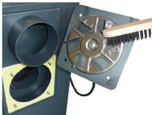
Ištraukiamo ventiliatoriaus valymas (modeliui D31P)
