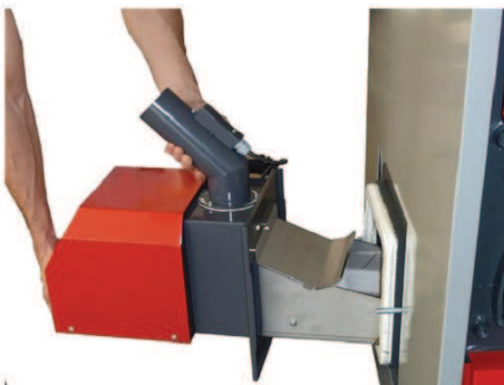
Degiklio išėmimas metiniam patikrinimui ir valymui
